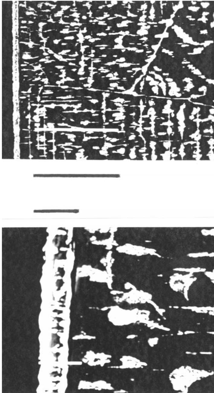
**Abb. 6.24.** Eisenhaltige Ausscheidungen im oxidierten Olivin  $(\text{Mg}_{0.9}\text{Fe}_{0.1})_2\text{SiO}_4$  nach einer Oxidation bei  $1200^\circ\text{C}$  an Luft. Die Deckschicht (links) besteht aus MgO und Magnesioferrit. Im Inneren des Kristalls haben sich an den Versetzungslinien Hämatit bzw. Magnetit gebildet. Länge der Balken: oben  $100\ \mu\text{m}$ , unten  $10\ \mu\text{m}$
